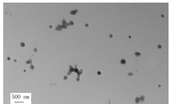
图 3 CPT-PPO 的透射电镜图
